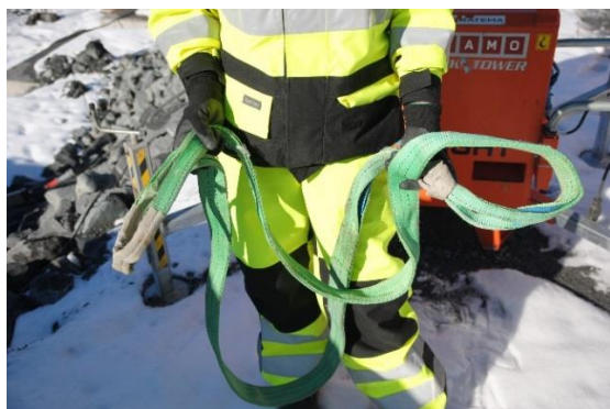
Figur 6: Lastestropper brukes stort sett kun en gang (foto: Eirik Wærner).
