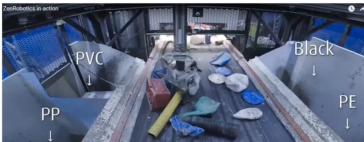
Figur 19. Bilde av sorteringsrobot fra ZenRobotics som sorterer hard plast i fire fraksjoner (Zen Robotics, 2022).
