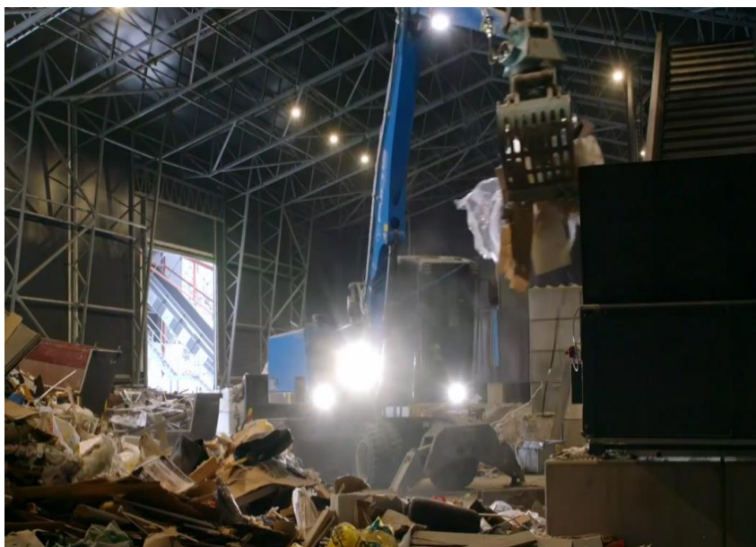
Figur 18 Bilde av gravemaskin som sorterer og legger avfall på transportbånd, Bjorstaddalen
