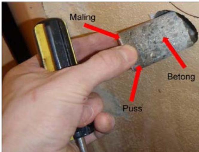
Figur 3 Prøvetaking med kjernebor (foto: NGI).
