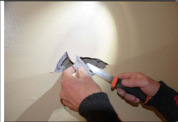
Figur 4 Prøve tatt av maling hvor noe av pusslaget kom med i prøven, resultat: Lave verdier (foto: Eirik Wærner).
